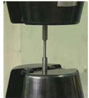
Éprouvette installée entre les mors de machine de traction
