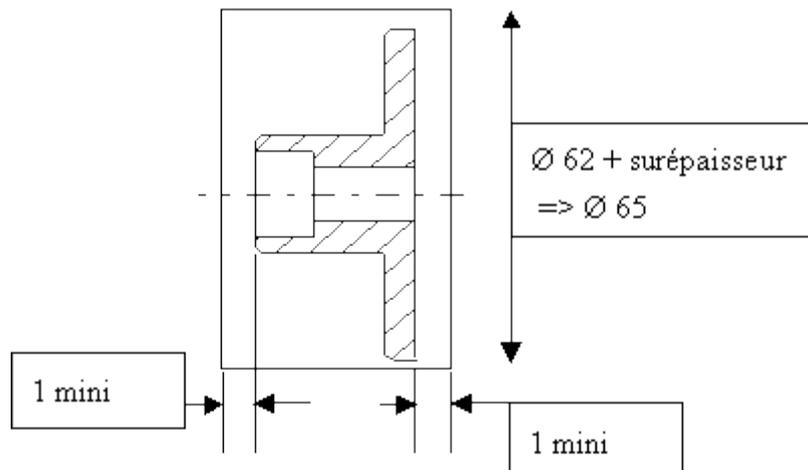
On doit vérifier qu'il existe ce type de matière au magasin : soit une barre pleine de  $\varnothing 65$  dont on coupera une longueur de 30 mm
