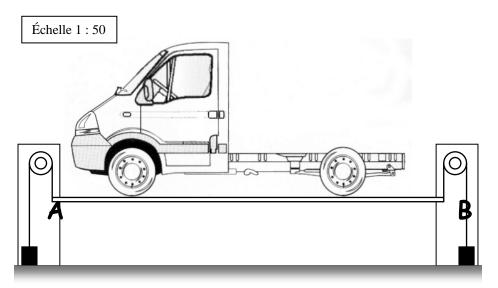
Ce véhicule utilitaire a un poids de 12000N sur le train avant et 6000N sur le train arrière.
