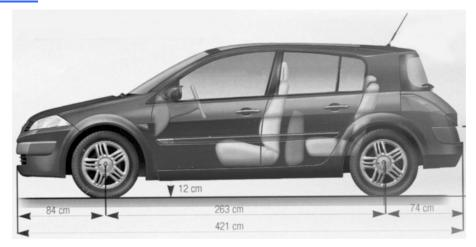
Sur ce véhicule, on relève 680kg sur le train avant et 485 kg sur le train arrière. On veut calculer son poids et la position du Cdt par rapport au train avant.
