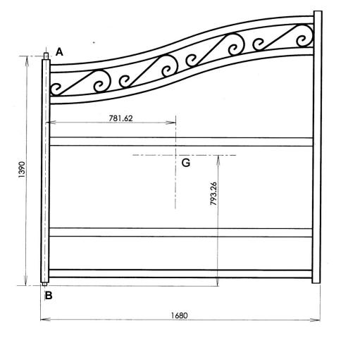
Ce vantail de portail (1), d'un poids de 300N est articulé en A sur un pilier (0) et en B au sol (0).
