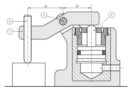
La bride hydraulique représentée ci-contre à l'échelle 1:2 est alimentée à une pression de 1Mpa.
