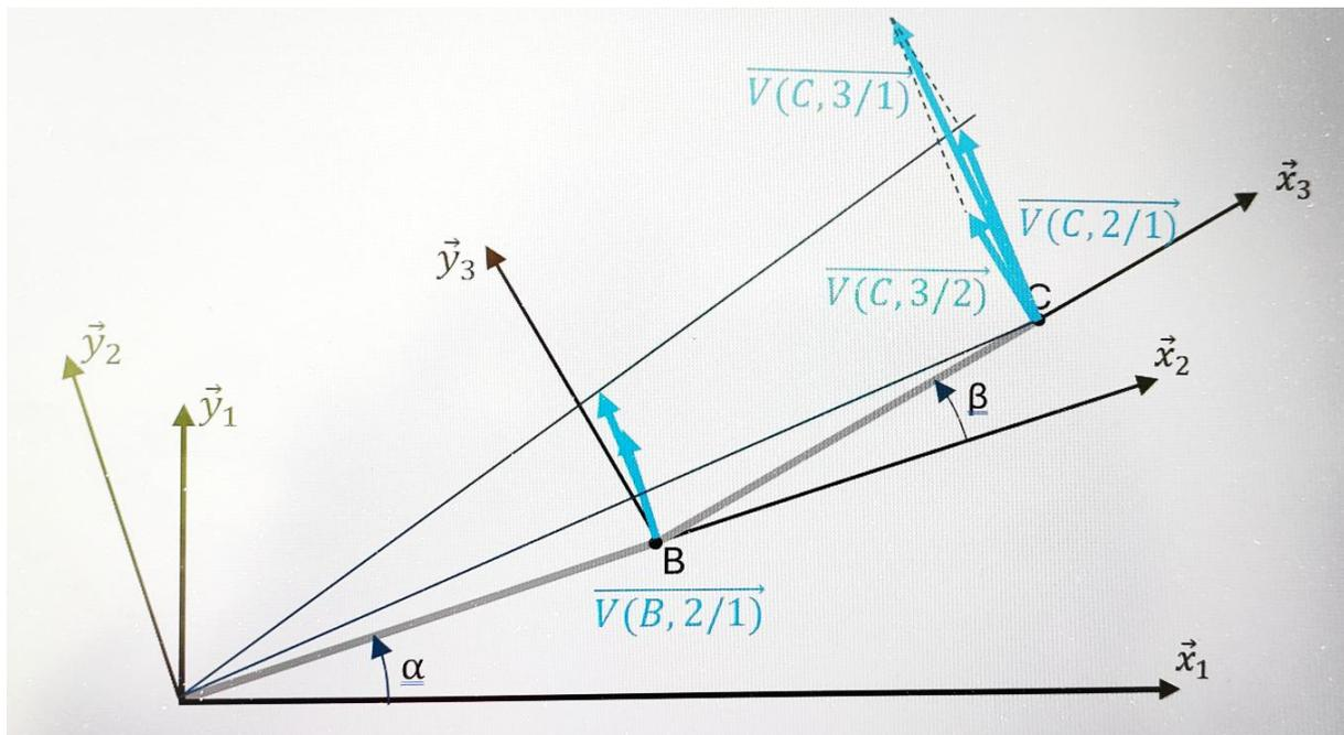
La description du mécanisme permet d'écrire les torseurs cinématiques associés aux mouvements 2/1 et 3/2
