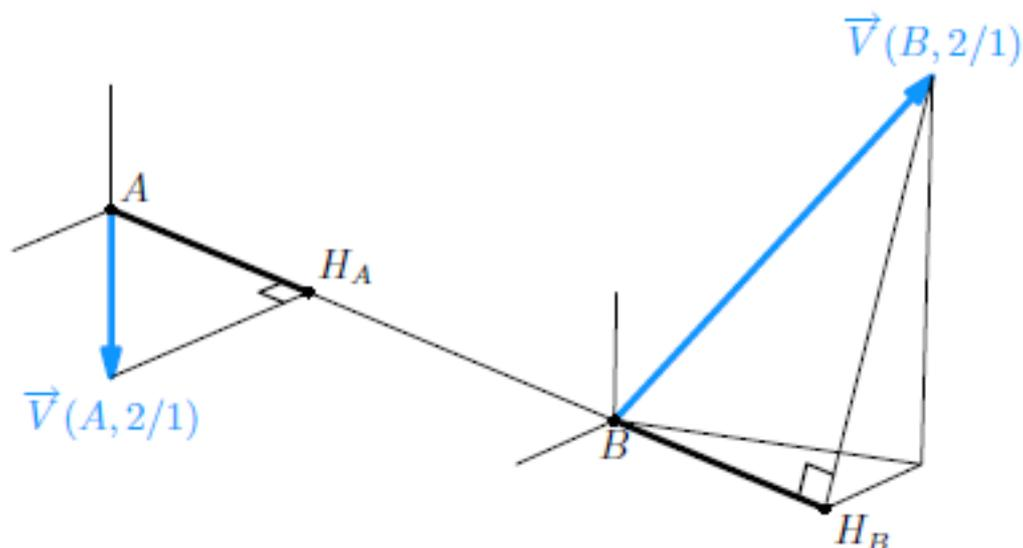
**Figure 3.8** Équiprojectivité du champ des vecteurs vitesses lors du mouvement d'un solide indéformable.
