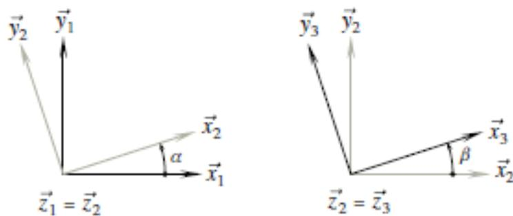
Alors que l'observateur attache assez naturellement le point  $C$  au solide 3, il est nécessaire de faire l'effort d'imaginer le mouvement de ce point  $C$  lié au solide 2 en fixant l'angle  $\beta$  pour comprendre le vecteur  $\vec{V}(C, 2/1)$ . Sans détailler ici les calculs, on trouve
